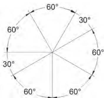
Figura 5.24: Orientação das cotas angulares - Método 2 (NBR 10126:1987).
