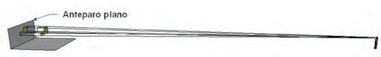
Figura 3.3: Distância tendendo ao infinito para se considerar as retas projetantes paralelas entre si.
