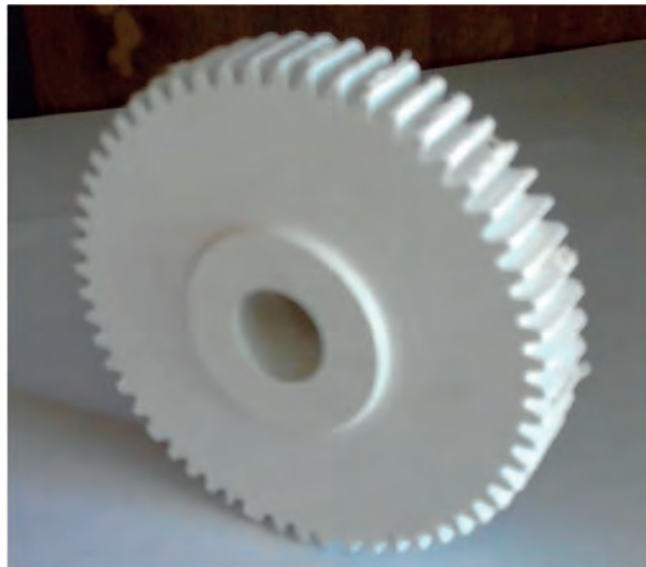
Figura 1.15: Engrenagem fabricada em CNC>. Cortesia: Departamento de Engenharia Mecânica - UFTM
