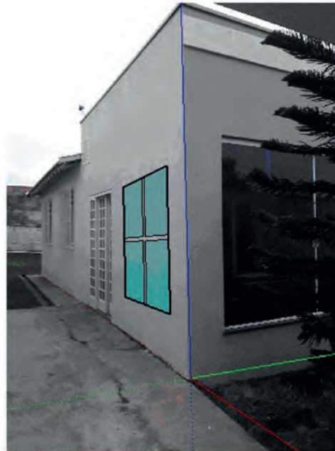
Figura 7.74: Desenho de formas geométricas em fotografia em software CAD utilizando perspectiva cônica.
