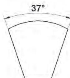
Figura 5.40: Cotação do ângulo formado entre as componentes retas da peça que se dirigem ao centro de origem do comprimento de arco.
