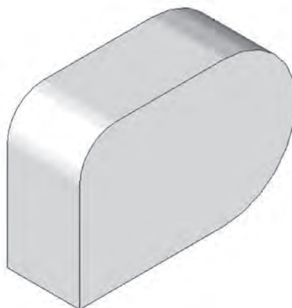
Figura 4.9: Figura com segmentos em arco.
